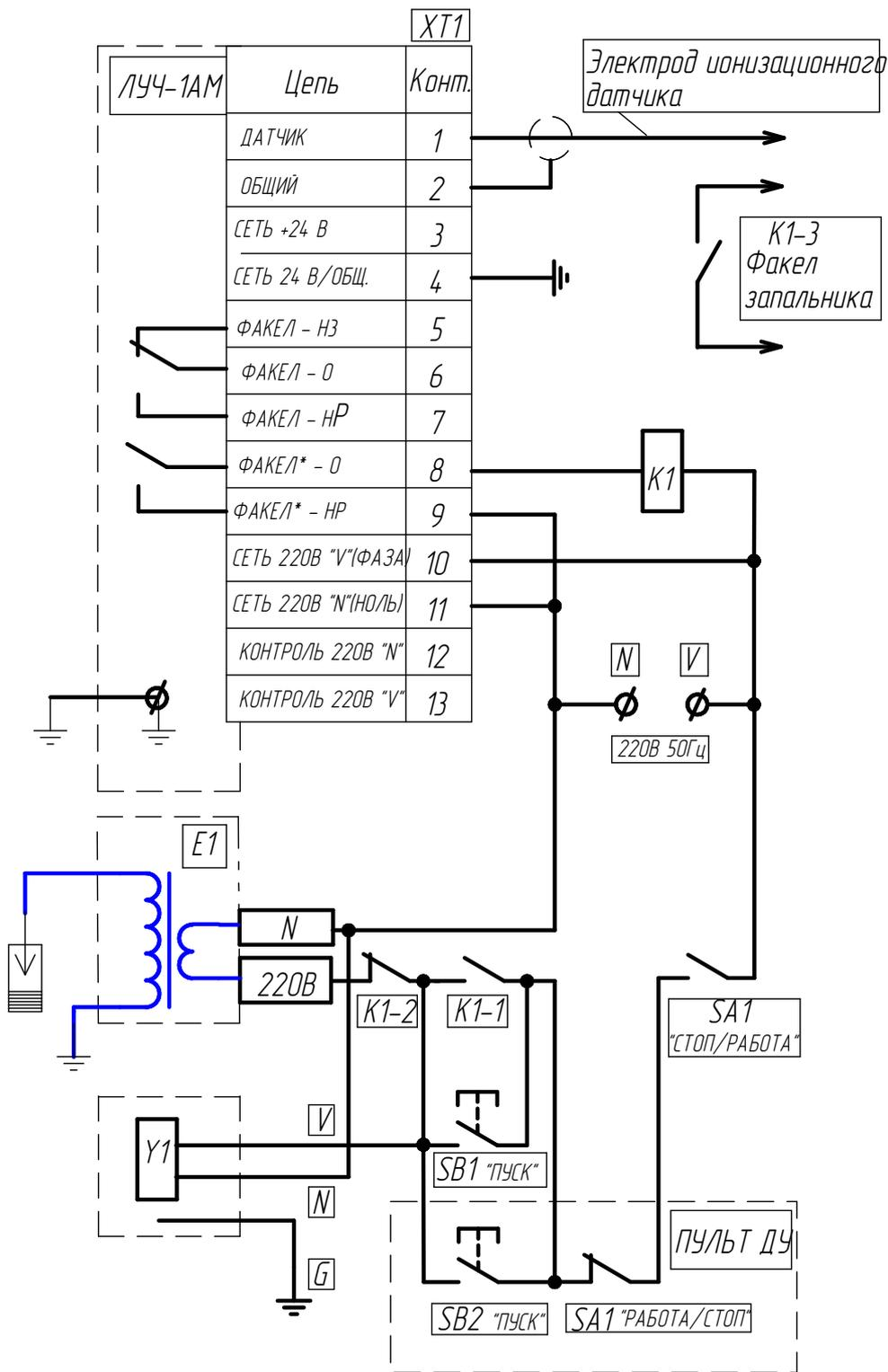
Типовая схема управления розжигом и контроля факела запальника сигнализатором горения ЛУЧ-1АМ.
